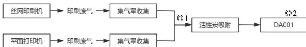
图3.2-1 废气处理工艺流程图
