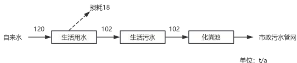
图2.2-1 本项目水平衡图
