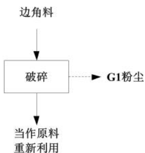
图2.3-3 本项目边角料破碎工艺流程及产污节点图
